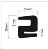
Dichtungsgummi für Kabinenscheiben
